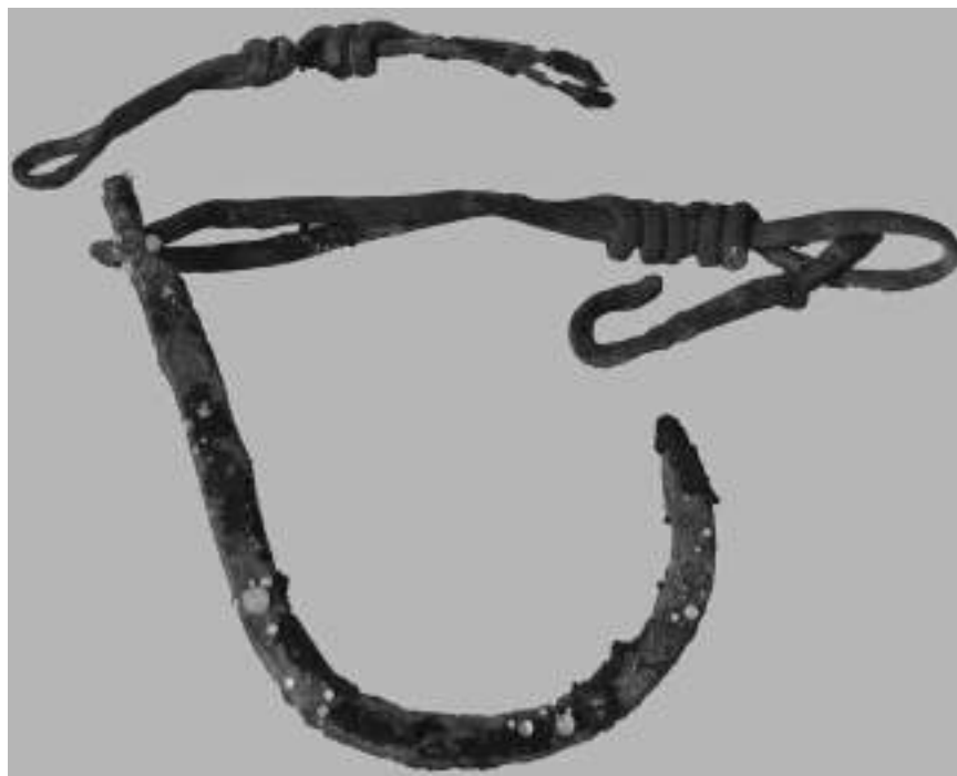
Fig. 2. Presencia de cloruros en anzuelo encadenado de bronce. Conjunto Arqueológico de Baelo Claudia . Foto M a . Luisa Millán.
