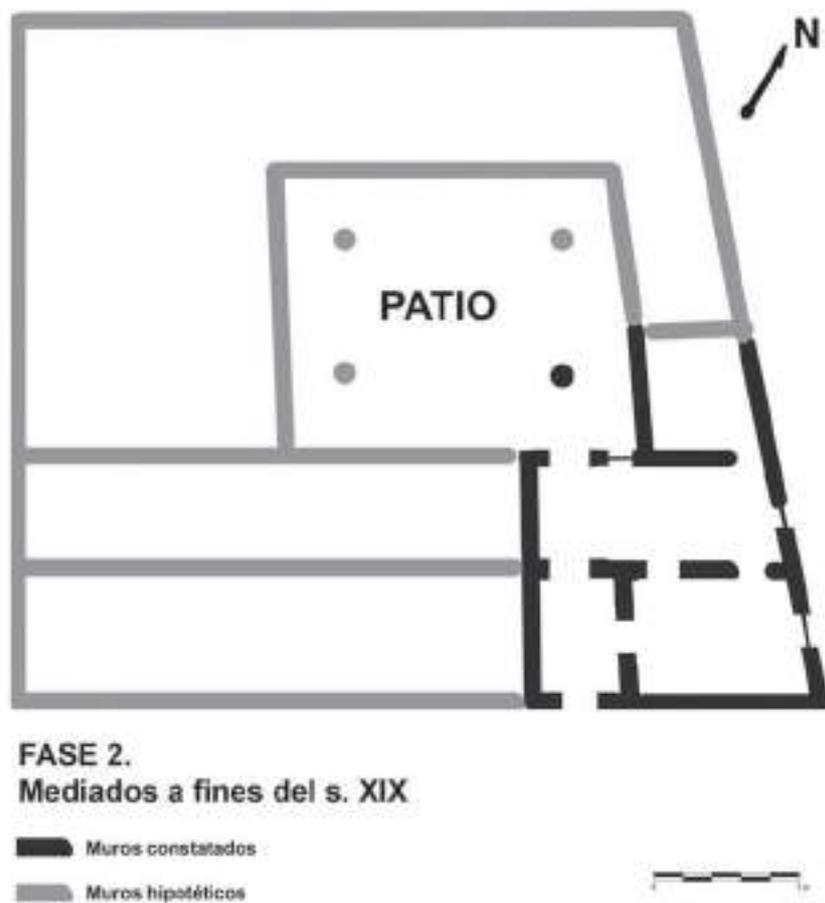
Fig. 37. Hipótesis de restitución de la fase 2 de la Casa de la Columna
